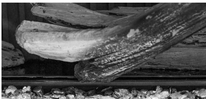
3. Faites glisser la bûche en forme de baleine sous la bûche arché en alignant les 3 points parallèle avec le bord du boîte a combustion comme indiqué. Positionner ensuite la bûche diagonale à l'aide de la goupille d'alignement et posé la vers le bas jusqu'à la bûche à baleine.
