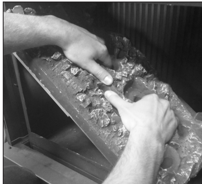
Figure 23. Retrait du brûleur - Rotation de 45 degrés
