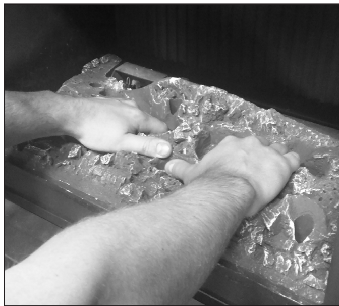
Figure 22. Retrait du brûleur - Positionnement correct de la main
