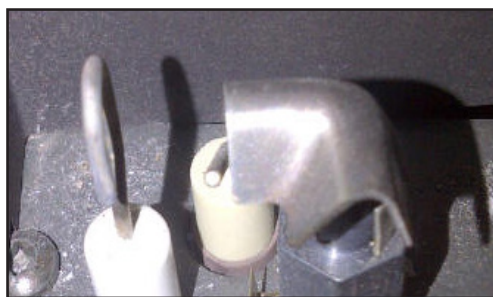
Figure 24. Position correcte de la tête du pilote
