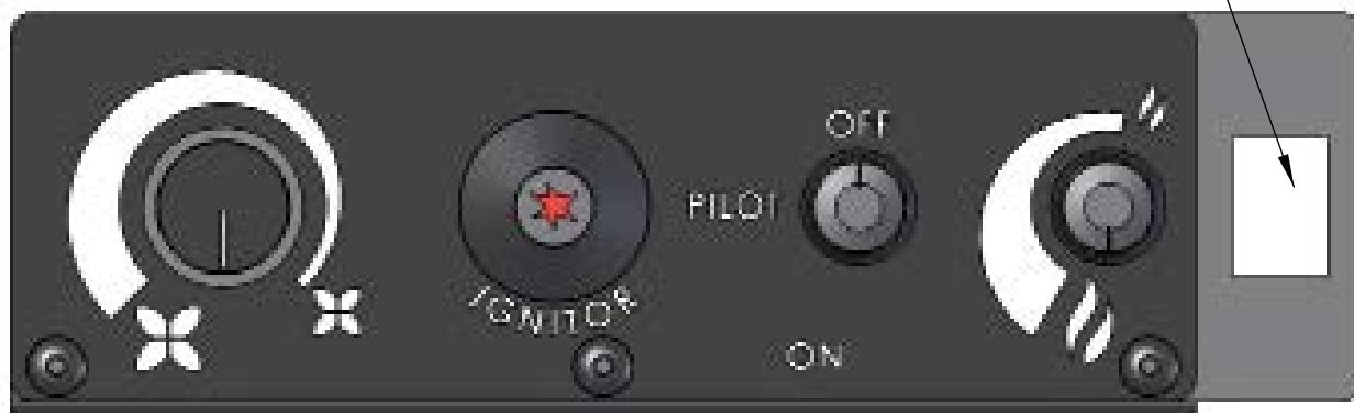
Figure 6: E30 Panneau de contrôle du E30
