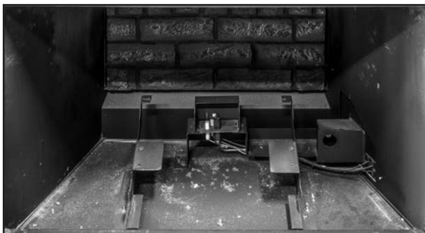
Figure 51: Soulevez le brûleur des supports et retirez-le de la boîte d'entrée. Dévissez les supports de panneau (T20) de chaque côté du déflecteur pour enlever les doublures latérales gauche et droite.
