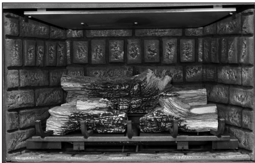
Figure 54: Placez les deux à gauche et à droite mi bûches au milieu du déflecteur d'air. Assurez-vous que les trous inférieurs sont alignés avec les goupilles dans le déflecteur d'air.
