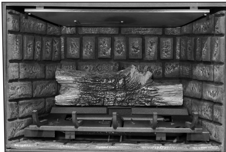
Figure 53: Installez la bûche arrière sur le pilote sur la plage arrière du déflecteur d'air. Poussez-le contre le panneau de briques arrière.
