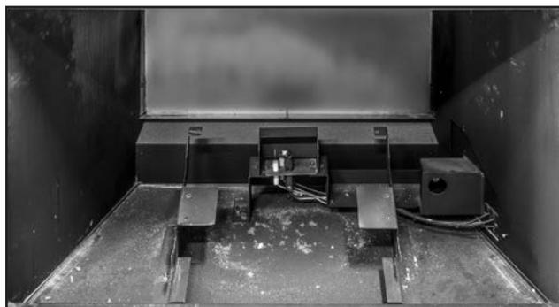
**Figure 49:** La doublure arrière peut maintenant être enlevée. Utilisez un aspirateur pour nettoyer la boîte à feu nue si nécessaire.
