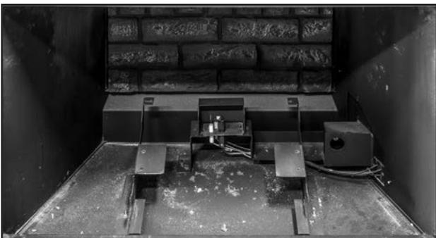
**Figure 48:** Soulevez le brûleur des supports et retirez-le de la boîte d'entrée. Dévissez les supports de panneau (T20) de chaque côté du déflecteur pour enlever les doublures latérales gauche et droite.
