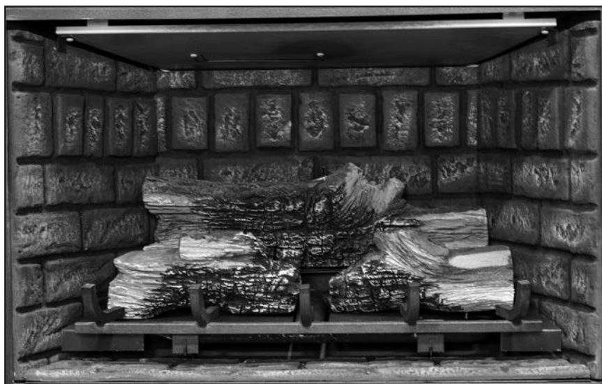
Figure 42: Placez les deux à gauche et à droite mi bûches au milieu du déflecteur d'air. Assurez-vous que les trous inférieurs sont alignés avec les goupilles dans le déflecteur d'air.
