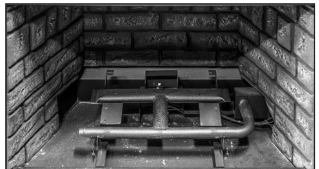
Figure 41: Retirez les 6 vis mises en évidence sur la figure 40 à l'aide d'un tournevis Torx T20 et retirez le déflecteur d'air.
