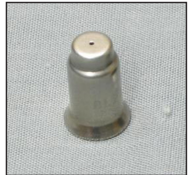
Figure 22. orifice de veilleuse
