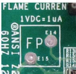
Deux blocs de détection de flamme se trouvent sur l'IFC, avec l'indication « FP ». Pour mesurer le courant de flamme, utiliser un multimètre réglé sur la tension en courant continu. Le courant de flamme varie selon le type de compteur utilisé. La plage de courant de flamme typique est comprise entre 0,75 et 3,0 microampères (0,75 à 3,0 V c.c.)
