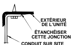
Figure 10. Fixation de conduits de circulation d'air horizontale
