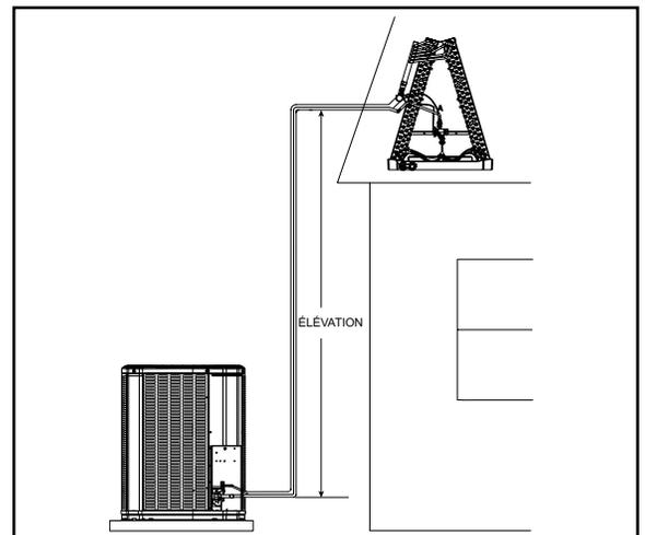
**ÉTAPE 2** - Déterminer la valeur de sous-refroidissement final en utilisant la longueur totale de conduite et l'élevation mesurée à l'ÉTAPE 1, ainsi que les tableaux ci-dessous.
