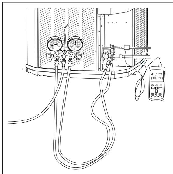
**ÉTAPE 5** - Utiliser la valeur de sous-refroidissement final, la pression et la température du frigorigène de l'ÉTAPE 4 afin de déterminer la pression relative du liquide appropriée en utilisant le tableau 14.2.
