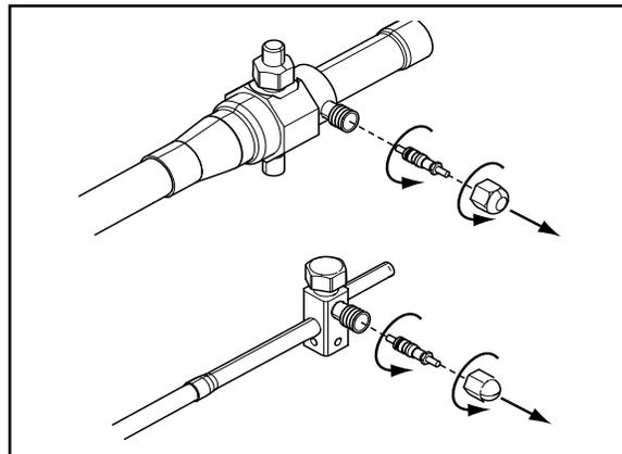
**ÉTAPE 3** - Purger les conduites de frigorigène et le serpentin intérieur avec de l'azote sec.
