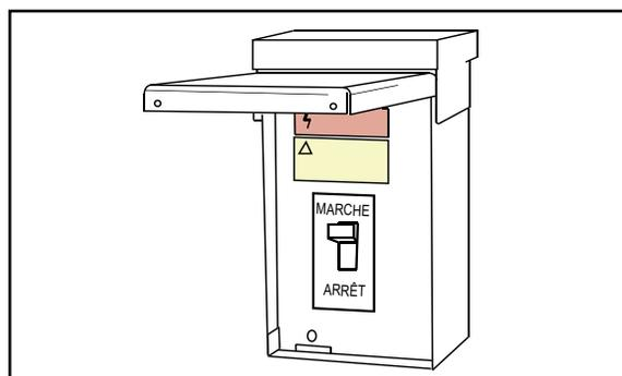
**ÉTAPE 4** - Attendre une (1) heure avant de démarrer l'unité si une résistance de carter compresseur est utilisée et que la température ambiante extérieure est inférieure à 21 °C (70 °F).
