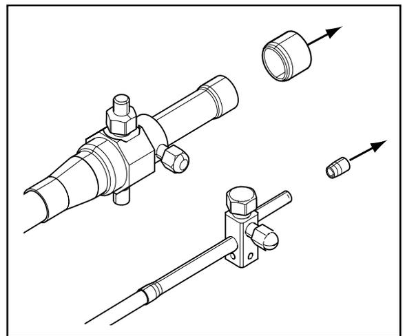
**ÉTAPE 2** - Retirer le capuchon de prise de pression et les obus de valve des deux robinets de service.
