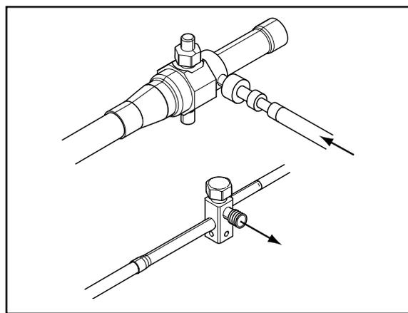
**ÉTAPE 4** - Envelopper le corps de la soupape d'un chiffon humide pour éviter les dégâts dus à la chaleur et continuer la purge à l'azote sec.
