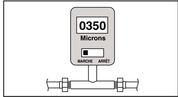
**ÉTAPE 2** - Observer le micro-manomètre. Le tirage à vide est complet et terminé si le micro-manomètre ne s'élève pas au-dessus de 500 microns en une (1) minute.
