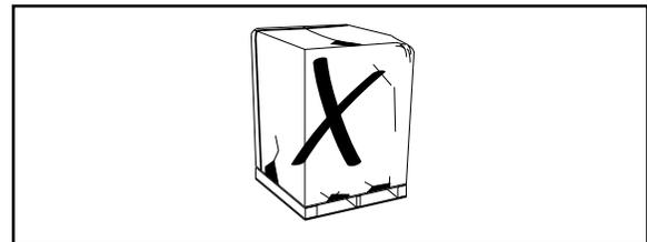
**ÉTAPE 2** - Pour extraire l'unité de la palette, retirer les languettes en les coupant à l'aide d'un outil tranchant.
