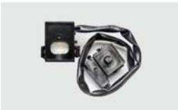
Un photocapteur allume automatiquement la veilleuse à DEL de 1 watt lorsque la pièce est sombre. Le commutateur haut/bas permet d'optimiser le niveau de noirceur requis pour que le photocapteur active la veilleuse. Ce module active aussi une minuterie de mise hors marche automatique de 20 minutes pour le ventilateur.
