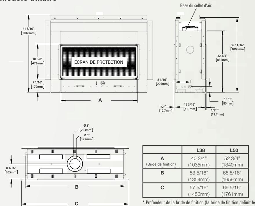
\* Profondeur de la bride de finition (la bride de finition définit le périmètre de l'ouverture du foyer. Les matériaux de charpente ou de finition ne doivent JAMAIS empiéter sur la bride de finition.
