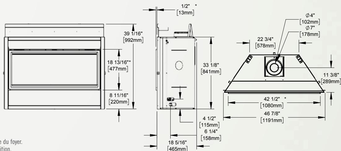
\* Profondeur de la bride de finition (la bride de finition définit le périmètre de l'ouverture du foyer).
