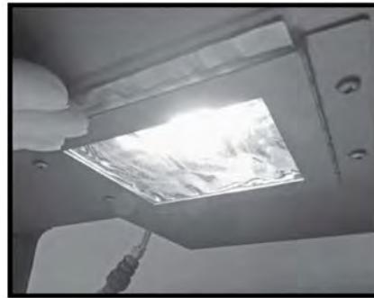
Figure 64: Insertion d'une lentille sans démonter son support.
