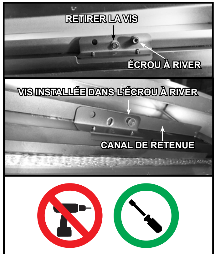
Figure 4.4 Retrait de la vis et installation dans l'écrou
