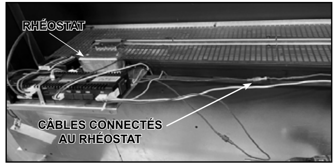
Figure 4.13 Démontage du rhéostat
