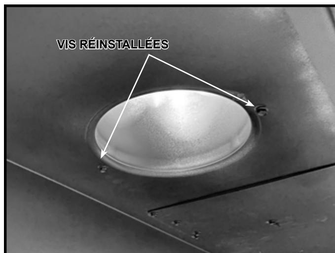
Figure 4.18 Réinstallation des vis
