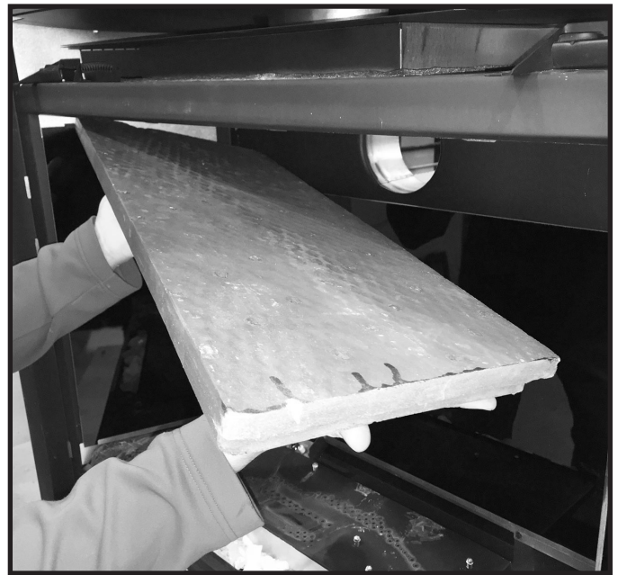
Figure 11.16 Installation du panneau réfractaire supérieur
