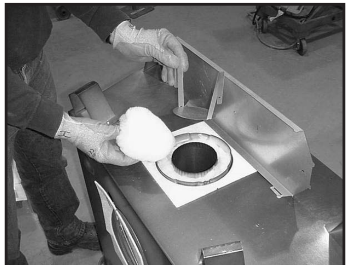
Figure 6.5 Retirez le panier d'isolation et l'isolant blanc du conduit d'évacuation central.
