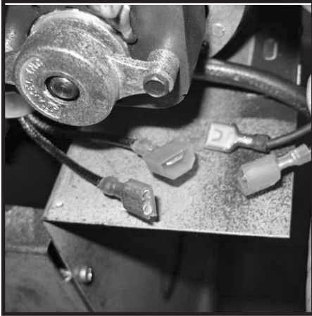
Figure 17: Débrancher les fils du ventilateur.
